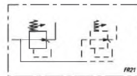
FR21 = Регулятор без сброса давления без манометра
