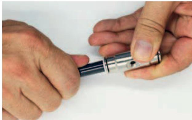
3. Разъединение трубопровода и фитинга. Нажмите на кольцо цанги, как показано на Рис.1. Воздействуя на кольцо цанги, потяните трубопровод в обратном направлении, как показано на Рис.2. Если возникают трудности с разъединением, рекомендуется использовать специальные ключи Мод. SP.
